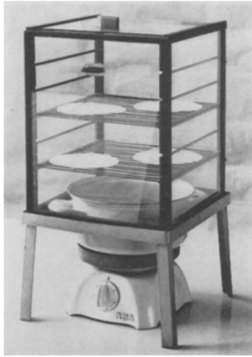
Abb. 3. Glas-Apparatur zur Essigsäurebedampfung von Spargelkeimlingen zum Nachweis anthozyanarmer Typen
